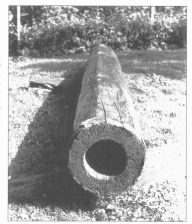
Erlenholzrohr der ersten St. Wendeler Wasserleitung; gefunden 1980 beim Bau der Tiefgarage in der "Mott"
