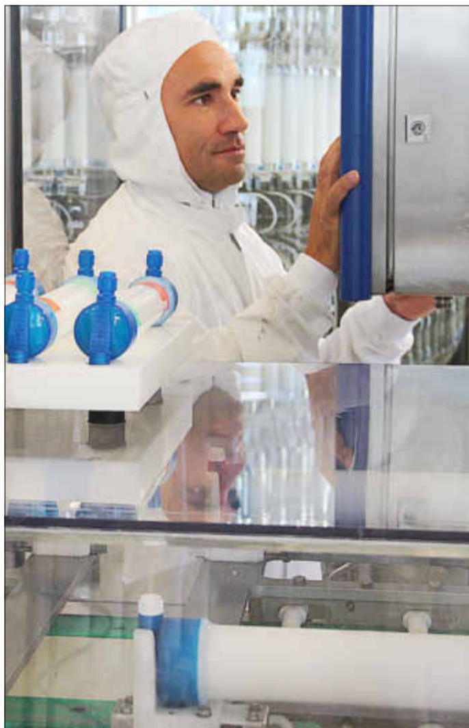
An Kontrollpanels wird die Produktion der Dialysefilter überwacht, die über ein Fließband am unteren Bildrand laufen. Foto: Fresenius
